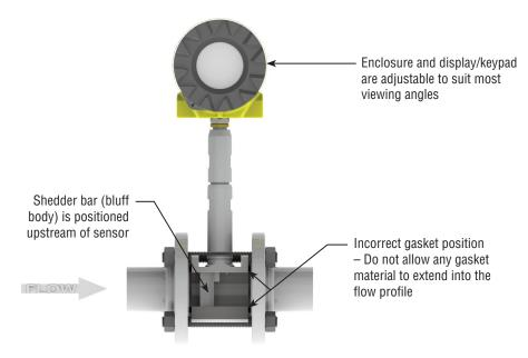
Figure 2-3. Wafer-Style Flow Meter Installation
