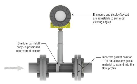
Figure 2-4. Flange-Style Flow Meter Installation
